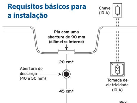
\*A saída de esgoto deve estar a 20 cm do fundo da pia ou a 45 cm acima do piso acabado se ainda não tiver sido instalado.
